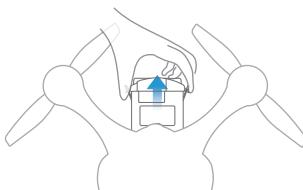
注：请勿在电池开机状态下插拔电池，否则可能会损坏电池。
