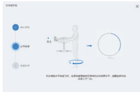
**第3步：**如图所示，机头朝下，校准人员手持飞机原地缓慢旋转，直到蓝圈全部点亮，将自动跳转到下一步骤。
